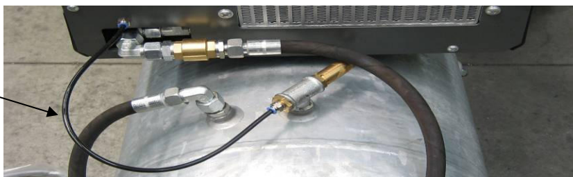
Рис. Шланг управляющего воздуха на ресивере.
